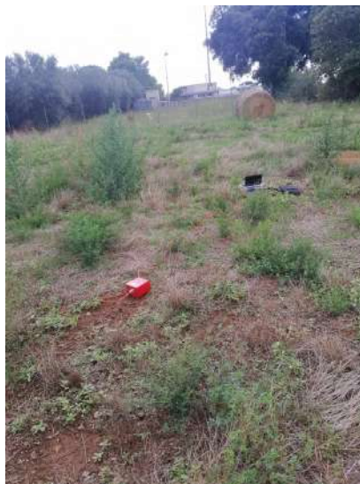
FOTO 7-12: Esecuzione prove sismiche indirette passive HVSR e attive MASW all'interno dell'area di lottizzazione.
