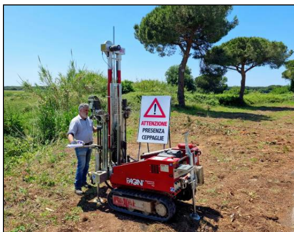
Realizzazione sondaggio penetrometrico S3
